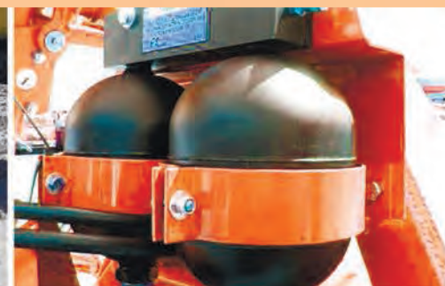
ОХЛАЖДЕНИЕ ГИДРАВЛИКИ, АЗОТНЫЙ АККУМУЛЯТОР
