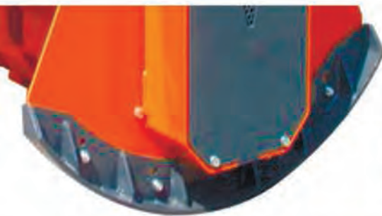
КОНТРОЛЬ ЗАГЛУБЛЕНИЯ В ГРУНТ
