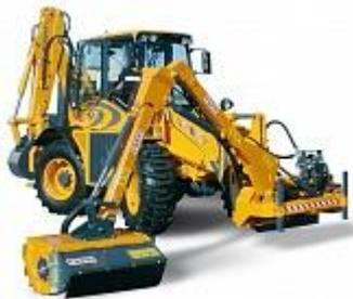
Косилка гибридного манипуляторного типа на экскаватор-погрузчик. Манипуляторная косилка устанавливается на погрузчик иностранного экскаватора-погрузчика, например John Deere, Venieri, Terex, Volvo, Caterpillar, JCB, Case, Hidromek, MST, Tarsus и другие. Купить косилку на экскаватор-погрузчик можно в исполнении с различными по типу лезвиями на рабочем органе.
